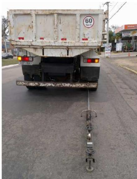
Foto 1 – Levantamento Deflectométrico com Viga Benkelman, Av. Boqueirão
