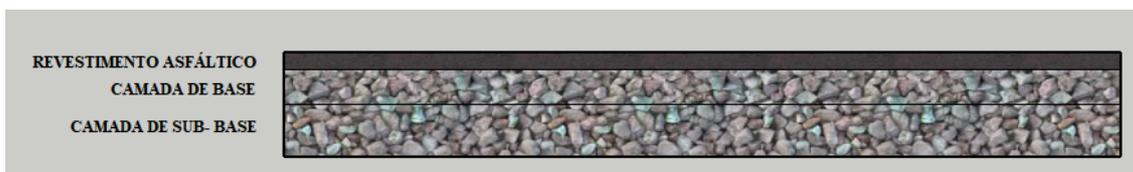
Revestimento asfáltico : 5,0 cm (obs: Av. Antônio Frederico Ozanan esp CBUQ=7 cm e nas Ruas C e Q esp CBUQ=6 cm conforme projeto do Loteamento Gravataí)
