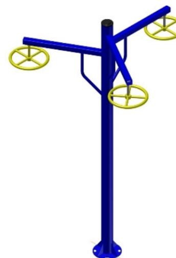
i) SIMULADOR DE PERCURSO DUPLO: Fabricado com tubos de aço carbono de 1", 1 ¼" e 2", espessura do aço de 2mm a 3mm, pedaleira em alumínio e pintura eletrostática à pó de alta resistência, 100% Poliéster, tampões em aço para proteção dos rolamentos, plaquetas em alumínio com especificação dos músculos trabalhados. Parafusos e porcas antioxidantes. Tipo de Instalação: Parabolt. Dimensões aproximadas: 0,82x1,64x1,22m. Cor: azul.
