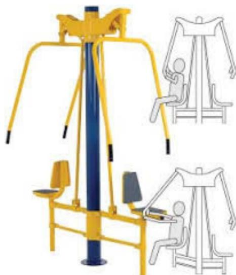
g) PRANCHA LATERAL: Fabricado com tubos de aço carbono de 1", 2", 3 ½", 4" e tubo retangular 50x30mm, espessura do aço de 2mm a 3mm, pedaleira em alumínio e pintura eletrostática à pó de alta resistência, 100% Poliéster, tampões em aço para proteção dos rolamentos, plaquetas em alumínio com especificação dos músculos trabalhados. Parafusos e porcas antioxidantes. Tipo de Instalação: Cadeirainha. Dimensão aproximada: 0,97x1,02x1,28m. Cor: azul
