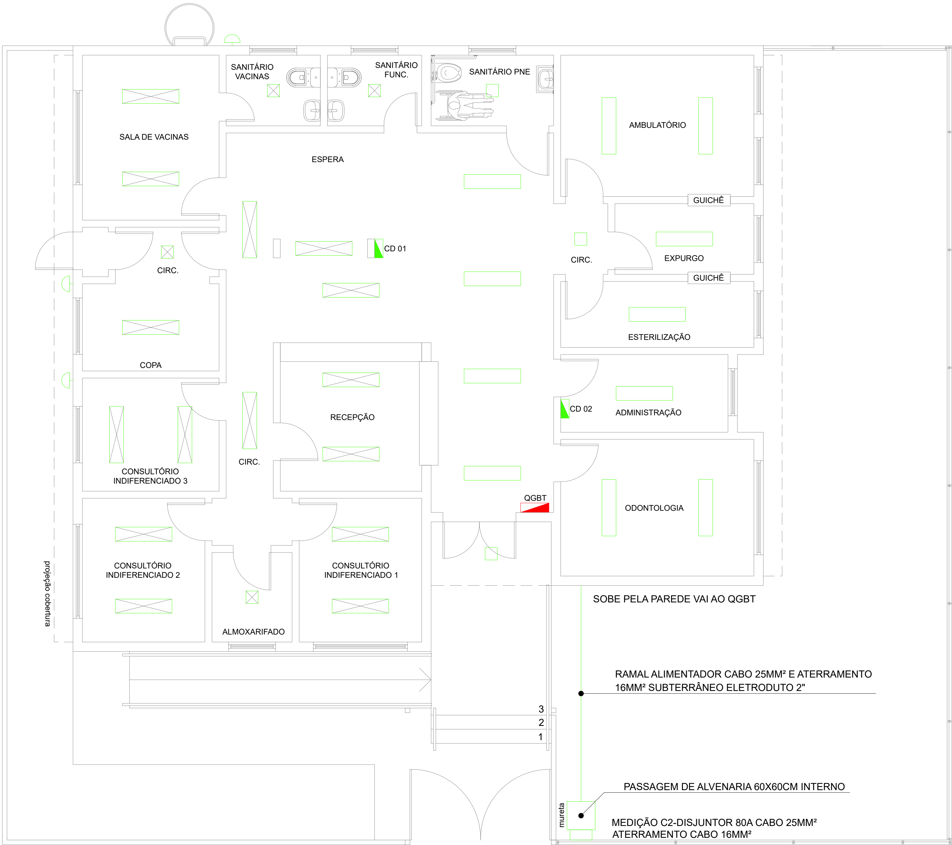
PLANTA ELÉTRICA Esc.: 1/50
