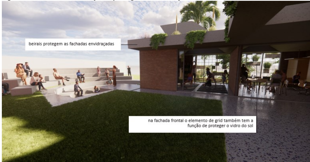
Figura 10 – fachadas envidraçadas protegidas de insolação direta.
