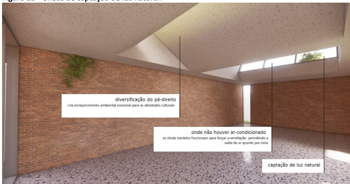
Figura 11 – Sheds de captação de luz natural.
