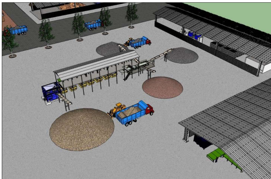
Figura 63 Peneira Vibratória, Esteira de Triagem e Britador de Entulho
