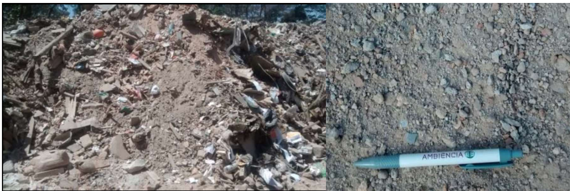
Figura 45 Exemplificação de RCD a ser triado, evidenciando o volume de finos e bica corrida reciclada
